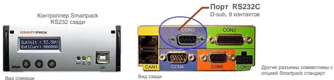
Иллюстрация 19 Контроллер Smartpack, опция RS232, доступ с задней стороны. Разъемы с передней и задней стороны
