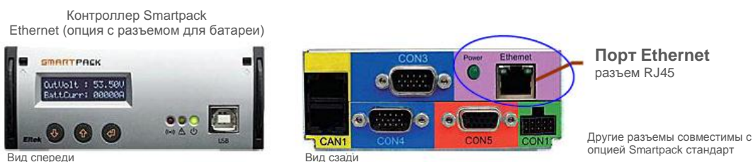
Иллюстрация 16 Контроллер Smartpack , опция с разъемами для подключения Ethernet и батареи
