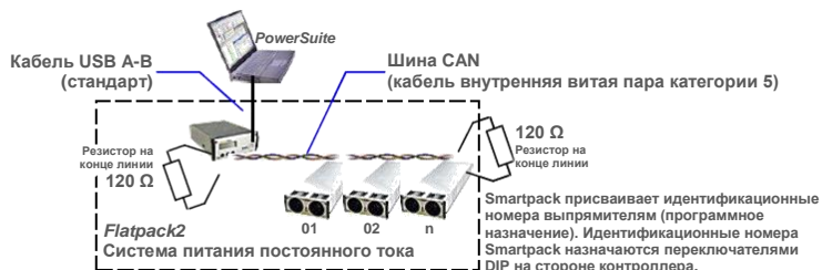
Иллюстрация 2 Шина CAN с концевой заделкой в виде резисторов на 120 \Omega с обоих концов линии (сопротивление шины 60 \Omega )
