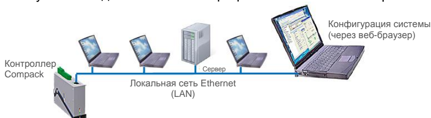
Иллюстрация 25 Конфигурирование системы питания с использованием веб-браузера
