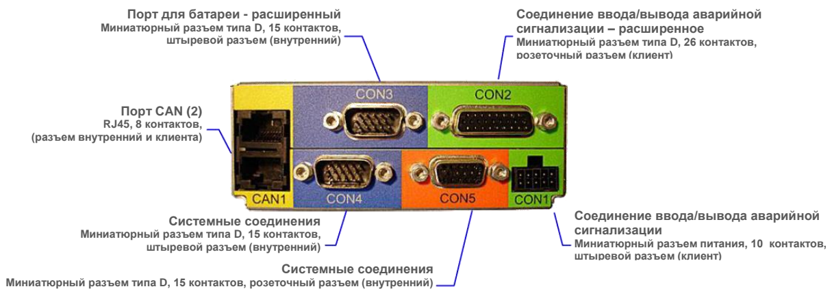
Иллюстрация 7 Порты подключения на задней панели расширенного контроллера батареи Смартпек
